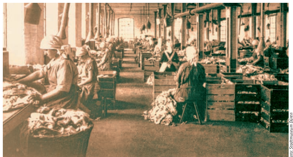
Zwischen dem 17. und 18. Jahrhundert wurden die pflanzlichen Fasern, die zur Papierherstellung nötig waren, tatsächlich aus Lumpen gewonnen – das Foto zeigt eine so genannte Lumpensortiererei.
